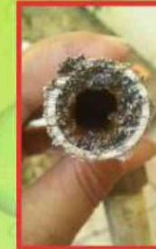
Contoh Kerak dalam pipa Air penyebab aliran kran kecil dan mampet
