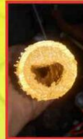
Contoh Kerak dalam pipa Air penyebab aliran kran kecil dan mampet
