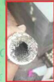
Contoh Kerak dalam pipa Air penyebab aliran kran kecil dan mampet
